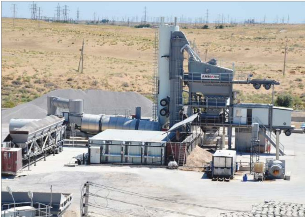
АБЗ-1 в г. Ашхабад АБЗ-2 в г. Ашхабад АБЗ состоит из 3-х асфальтобетонных заводов, суммарной производительностью 800 т/ч
